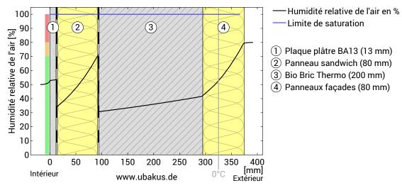
Notes: Calcul utilisant la méthode 2D-FE d'Ubakus. La convection et la capillarité des matériaux de construction n'ont pas été prises en compte. Le temps de séchage peut prendre plus de temps dans des conditions défavorables (ombrage, étés humides / frais) que celui calculé ici.
