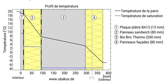
Course de la température et du point de rosée dans la composition. Le point de rosée indique la température à laquelle la vapeur d'eau condensera. Si la température de la composition est au dessus de température de condensation il n'apparaît pas d'eau liquide. Si les deux courbes viennent à se toucher, il se forme en ce point de la condensation.
